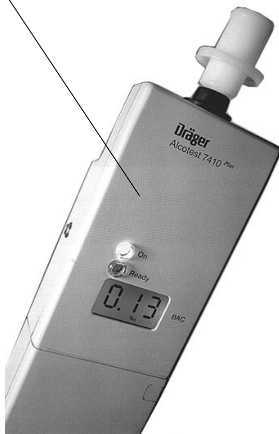
Slika 1: Etilometar tip Alcotest 7410 plus s prikazom mjesta za
